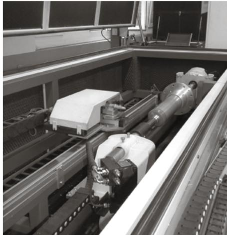
Das ASCOJET-Strahlgerät samt Düse ist schallgeschützt in einer geschlossenen Anlage mit integriertem Absaugsystem untergebracht – für eine absolut geräuscharme Umgebung.
